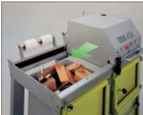
DIXI 5 S-K: puristettaessa mäntä laitetaan syöttökammion päälle ja siirretään sivuun kammiota täytettäessä.
