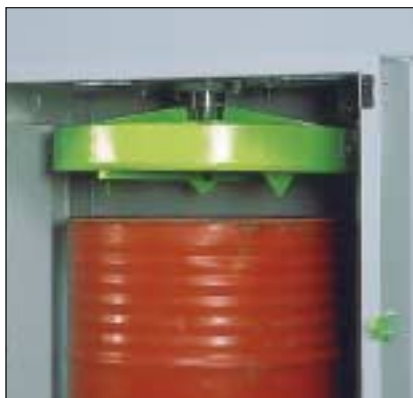
Suuren puristuslevyn piikit reiättävät tynnyrinkannen
