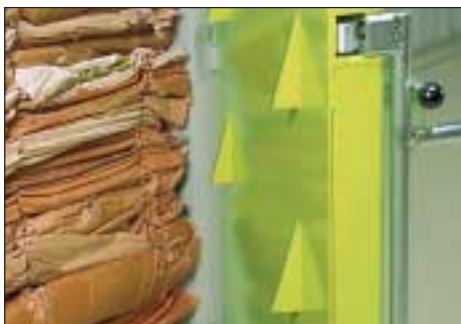
Täydellistä: hammaspidikkeet estävät jäykkiä materiaaleja kimpoamasta takaisin.
