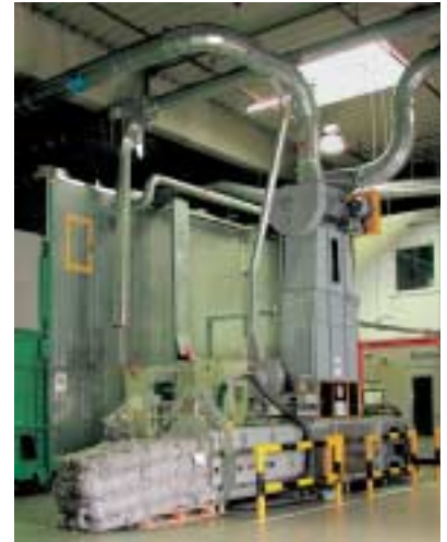
Dixi SLK 60 toteutus ilmakuljetusjär- jestelmällä painotalossa
