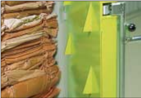
Täydellistä: hammaspidikkeet estävät jäykkiä materiaaleja kimpoamasta takaisin.
