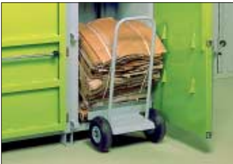
Puristettujen paalien siirtäminen on helppoa paalikärryllä.
